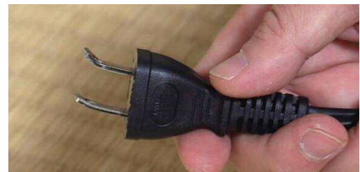
変形した電源プラグ
