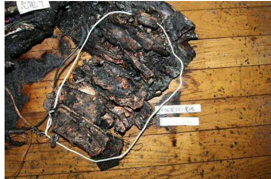
写真 1-2 焼損した電池
