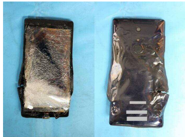
写真 2-2 スマートフォンの焼損状況
